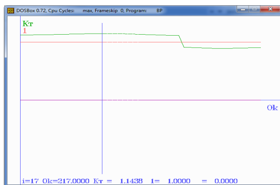
Рис. 3. График значений коэффициента k_T ползуна для одного оборота кривошипа
